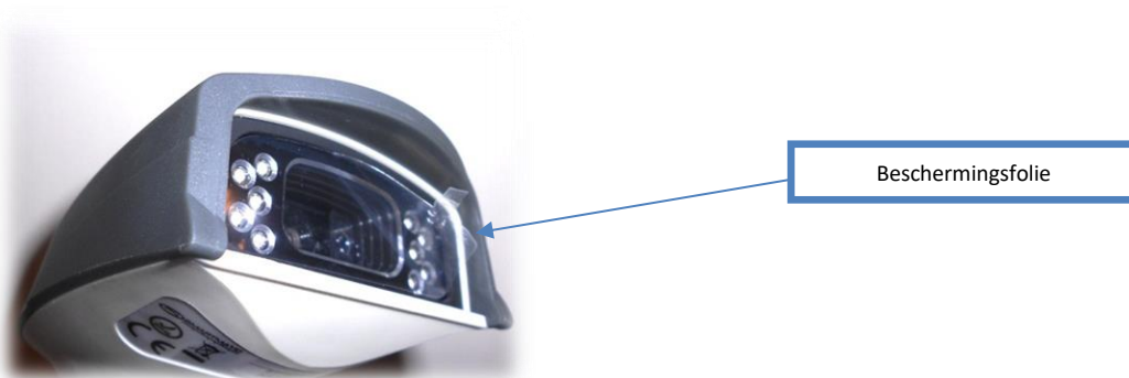
Figuur 25 handscanner met beschermingsfolie
