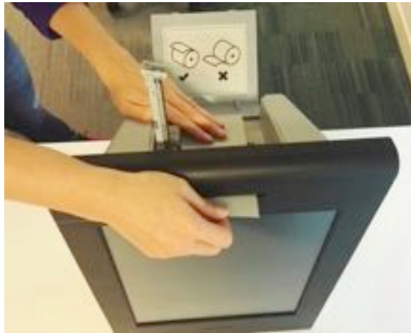
Figuur 23 : papier met de grijze kant boven door de opening
