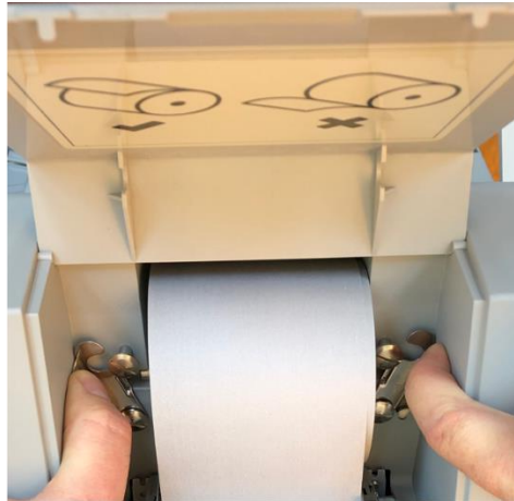
Figuur 60. Ontgrendeling clips
